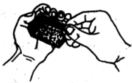
Рис. 20 Удалите нагар с игольчатого клапана
