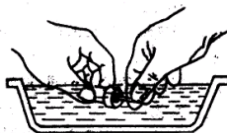
Рис. 21 Промойте корпус форсунки и игольчатый клапан
