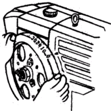
Рис. 18 Отметка ВМТ на маховике
