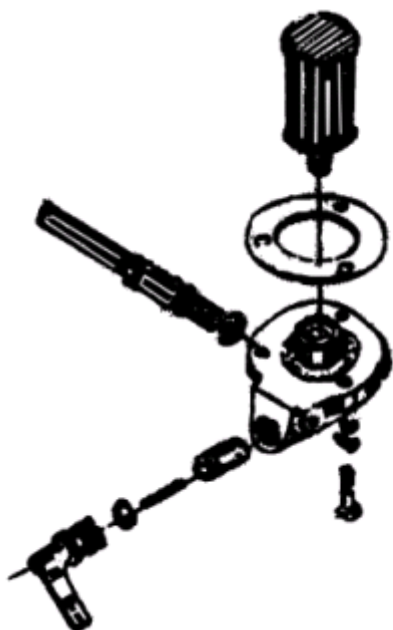
Рис. 9 Укомплектованный топливный фильтр (а) топливный фильтр модели 185-11200А (б) топливный фильтр модели 180N-10300С
